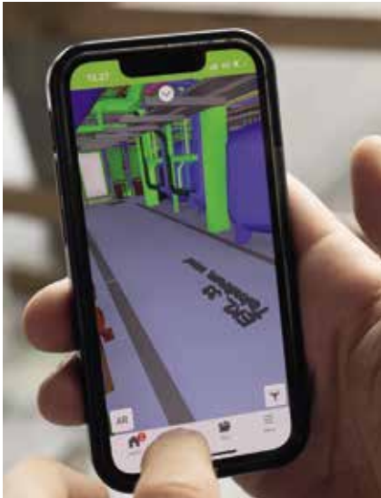
Rundt på byggepladsen kan en mobil vise i 3D, hvordan rummet kommer til at se ud, når det er færdigt.
